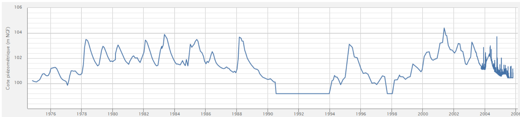
Illustration n° 27 : Hauteur altimétrique de la nappe entre 1974 et 2005 à Beaumont (Source : ADES)
