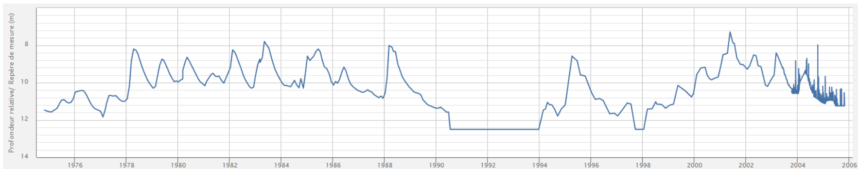
Illustration n° 26 : Profondeur de la nappe entre 1974 et 2005 à Beaumont (Source : ADES)
