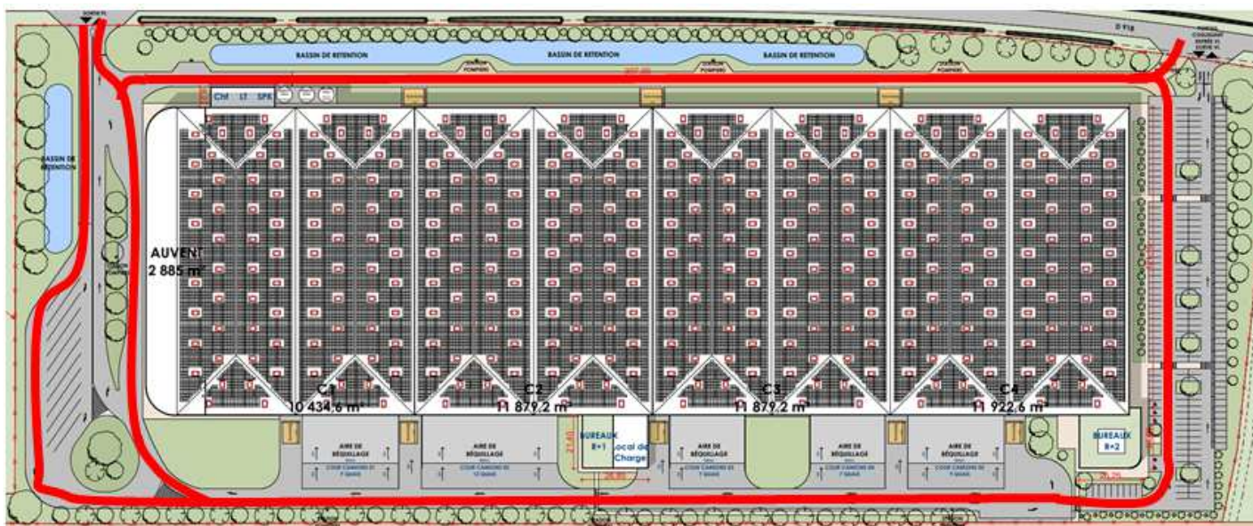
Illustration n° 63 : Cheminement pompier sur le site
